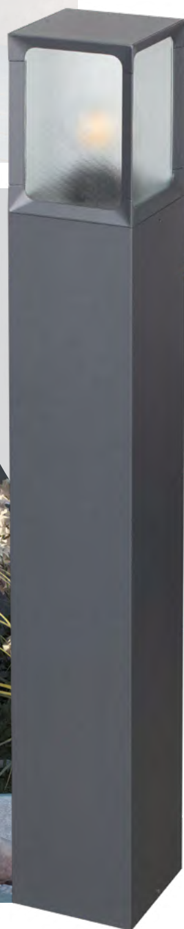
370947 IP 54 370948 Светильник ландшафтный Алюминий/стекло E27 max 18 Вт 220-240 В Диапазон раб. тем-р от -20° до +40° С
