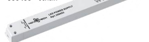
IP 20 Драйвер Пластиковый корпус Выходная мощность: 150 Вт Выходное напряжение: 48 В Входное напряжение: 100–240 В (Д*Ш*В) 322,6*30*21,5 мм
