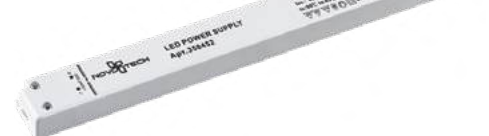
IP 20 Драйвер Пластиковый корпус Выходная мощность: 100 Вт Выходное напряжение: 48 В Входное напряжение: 200–240 В (Д*Ш*В) 320,6*30*18,2 мм
