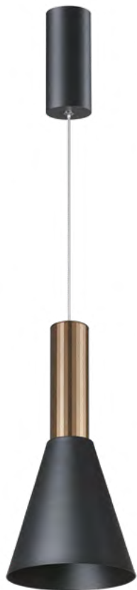
358982 IP 20 358983 Светильник накладной светодиодный 358984 Длина провода 2 м 358985 Алюминий 358986 15 Вт 220 В 1200 Лм 4000 К Цвет LED белый Угол рассеивания 60°
