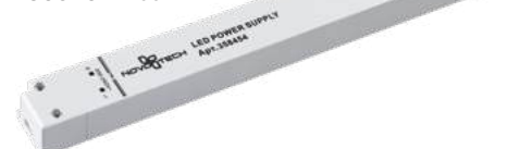
IP 20 Драйвер Пластиковый корпус Выходная мощность: 240 Вт Выходное напряжение: 48 В Входное напряжение: 200–240 В (Д*Ш*В) 356,4*32*22,3 мм
