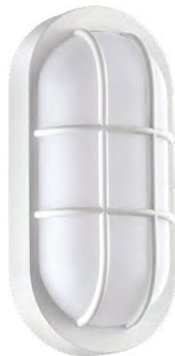
358916 IP 65 358917 Светильник ландшафтный настенный светодиодный Поликарбонат 10 Вт 85-265 В 900 Лм 4000 К Диапазон рабочих температур от -30° до +40° С Цвет LED белый Угол рассеивания 120°
